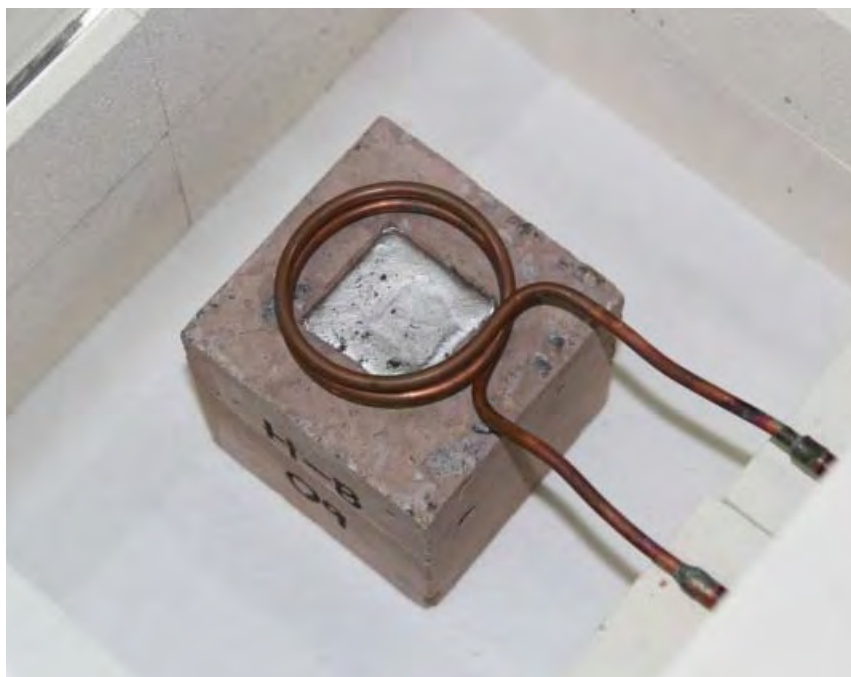
รูปที่ 11 โลหะเหลวใน High density concrete ซึ่งมี Heating coil อยู่ด้านบน (ยังไม่ได้ใส่ฉนวนกันความร้อนรอบๆ Coil เพื่อให้สามารถเห็นโลหะเหลวได้อย่างชัดเจน)
