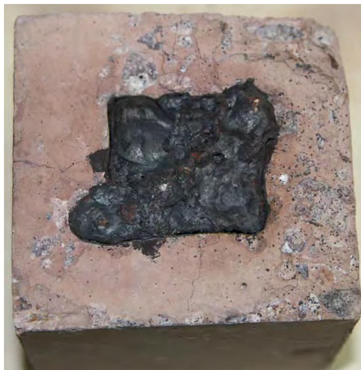
7(d) โลหะเหลวที่เทลงใน High-density concrete (ในรูปได้กลายเป็นของแข็งแล้ว) รูปที่ 7(a) - 7(d) การทดลองหลอมโลหะและเทลงใน High-density concrete โดยใช้ เครื่อง Arc plasma
