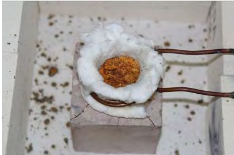
รูปที่ 13 ตัวอย่างการฟอร์มตัวของวัสดุแข็งสีเหลืองส้มด้านบนของโลหะเหลว (ในความเป็นจริงแล้วได้ทำการทดลองเบื้องต้นในลักษณะนี้หลายครั้งเพื่อดูความเป็นไปได้ของการทดลองใหม่นี้ ทำให้แต่ละรูปไม่ใช่มาจากการทดลองครั้งเดียวกัน)
