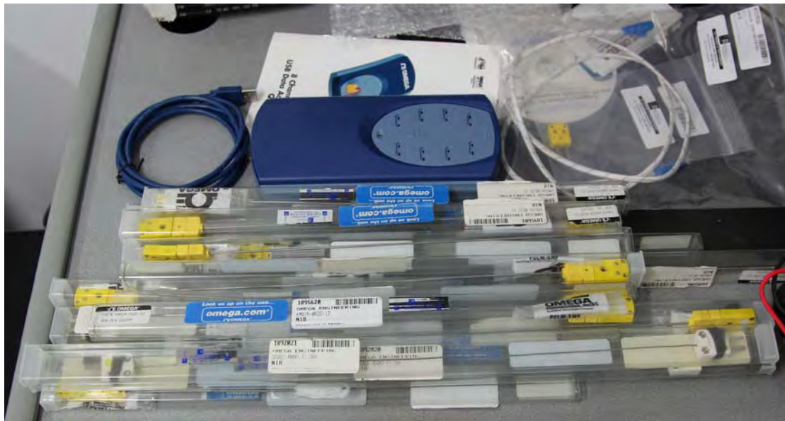
รูปที่ 2 Thermocouple โลหะทำ Thermocouple junction และ 8-channel data acquisition board (ไม่ใช่ในงานนี้เพราะจะใช้ Infrared pyrometer แทน)
