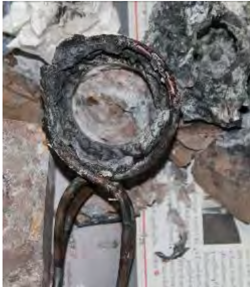
10(c) Coil ที่เกิดความเสียหายละลายไปบางส่วน รูปที่ 10(a) - 10(c) ความเสียหายที่เกิดขึ้นบริเวณชิ้นงานและ Coil
