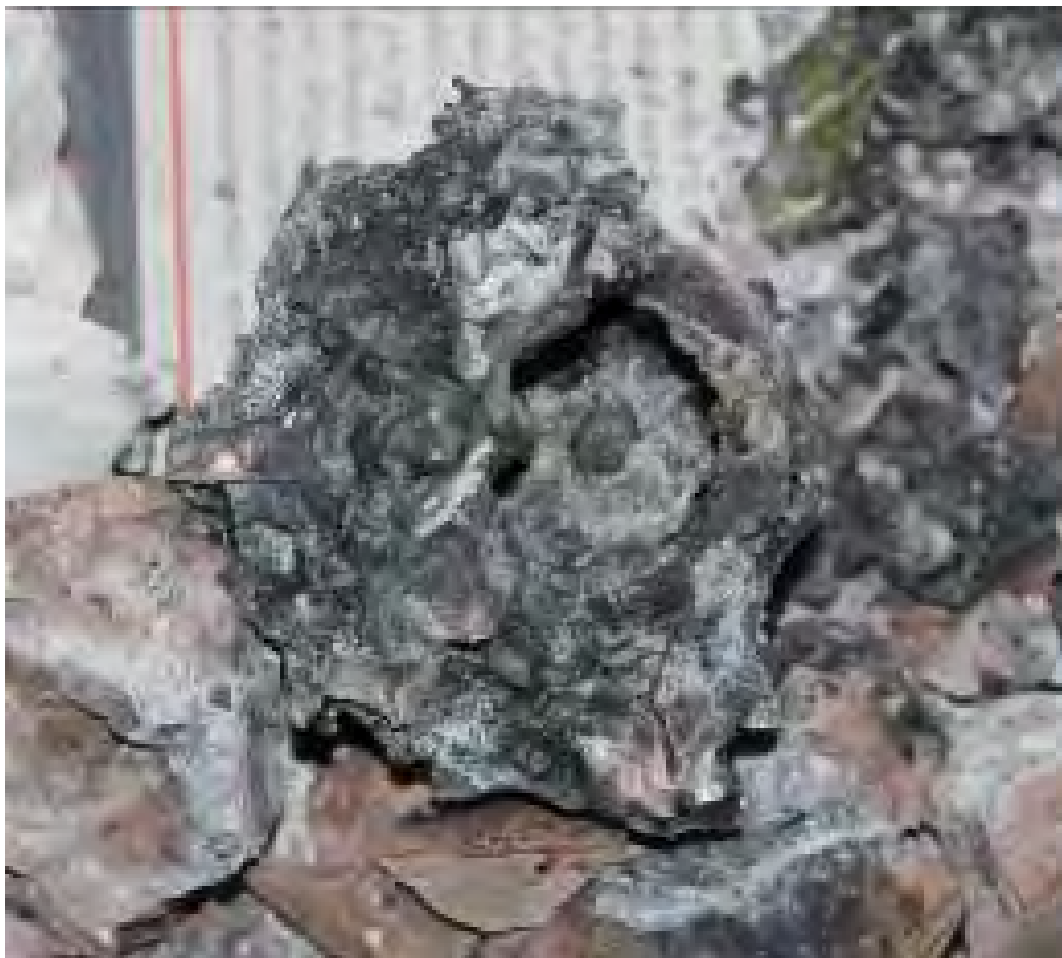
10(b) บริเวณที่ Zirconium หลอมละลายออกมา (มองจากด้านล่าง)
