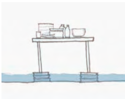
ภาพที่ 9 (ซ้าย) ยกเครื่องเรือนให้สูงกว่าระดับน้ำโดยใช้บล็อกคอนกรีตที่เตรียมไว้ในการทำกำแพงกันน้ำ (กลาง) ใช้ยางรถยนต์รองแผ่นไม้เป็นทางเดินติดต่อกันระหว่างบ้าน (ขวา) ยกสุขาชั่วคราวให้สูงระดับน้ำท่วมที่คลองบึงไผ่ ที่มา: วาดโดยคณะผู้วิจัย
