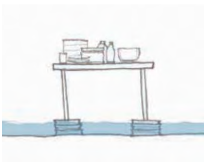
ภาพที่ 2 (ซ้าย) ยกเครื่องเรือนพื้นน้ำโดยใช้บล็อกคอนกรีตที่เตรียมไว้ในการทำกำแพงกันน้ำ (กลาง) ใช้ยางรถยนต์รองแผ่นไม้เป็นทางเดินติดต่อระหว่างบ้าน (ขวา) ส้วมชั่วคราวยกสูงระหว่างน้ำท่วมที่คลองบึงไผ่
