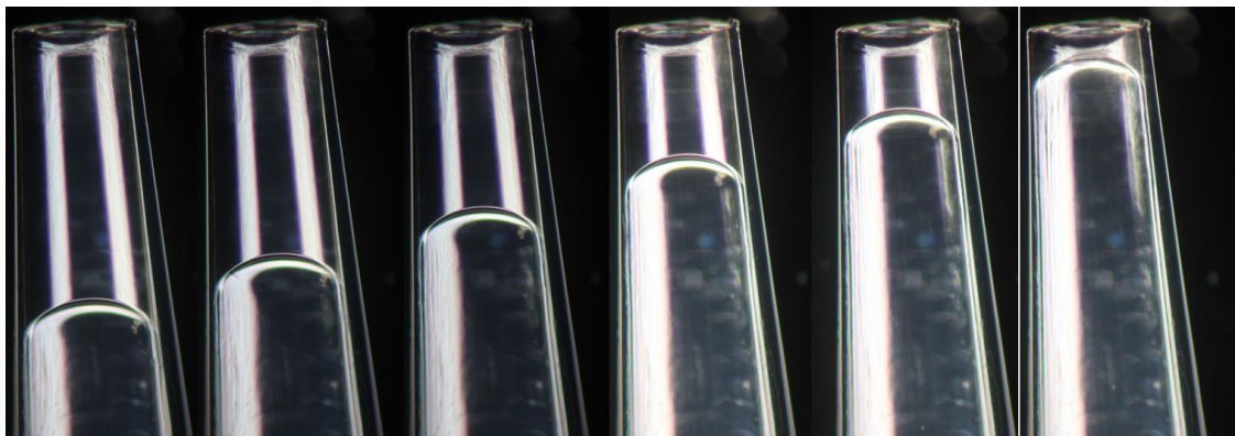
ภาพ 18 ภาพถ่ายต่อเนื่องของการลดปริมาตรลงอันเนื่องมาจากการระเหย ของคลอโรฟอร์มในระบบ lab on a tip ที่พัฒนาขึ้น ในภาพ หยดสารละลายใสที่อยู่ปลายปิเปตทิปคือคลอโรฟอร์ม ของเหลวที่อยู่ถัดมาคือน้ำ ซึ่งทำหน้าที่เป็น stop cock ที่ควบคุมให้การระเหยเกิดขึ้นที่ปลายปิเปตทิปเพียงด้านเดียว แต่ละภาพถ่ายห่างกัน 15 วินาที
