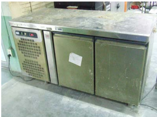
รูปที่ 3-9 ตู้อบก้อนตัวอย่างแบบควบคุมอุณหภูมิ
