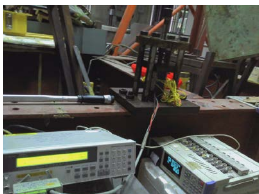
รูปที่ 3-25 ภาพการวัดค่าความต้านทานทางไฟฟ้าและค่าความเครียด
