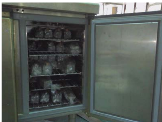
รูปที่ 3-20 ภาพการนำก้อนซีเมนต์เบสเส้นเซอร์มาอบด้วยตู้อบ
