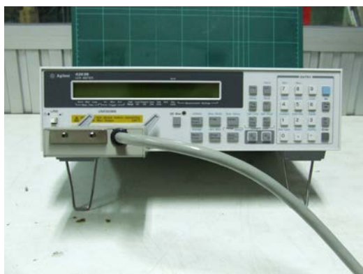
รูปที่ 3-8 เครื่อง LCR Meter : Agilent 4263 B
