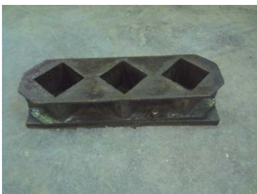
รูปที่ 3-10 แบบหล่อก้อนตัวอย่างขนาด 5 \times 5 \times 5 cm
