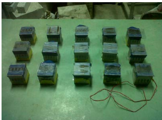
รูปที่ 3-23 ภาพการติดตั้ง Strain Gauge
