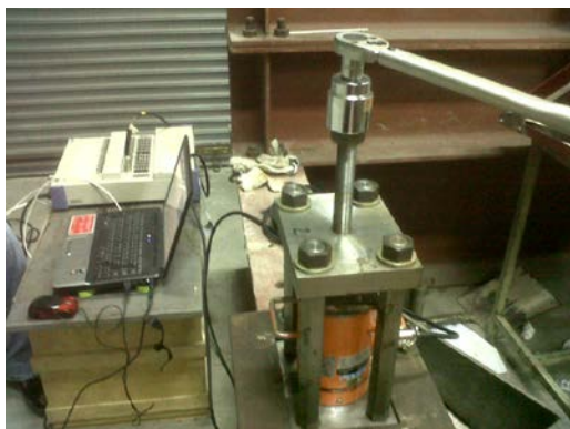
รูปที่ 3-15 รูปการไขเครื่องกดแบบคงค้ำ โดยประแจทอร์คเพื่อเก็บค่าจาก Load Cell
