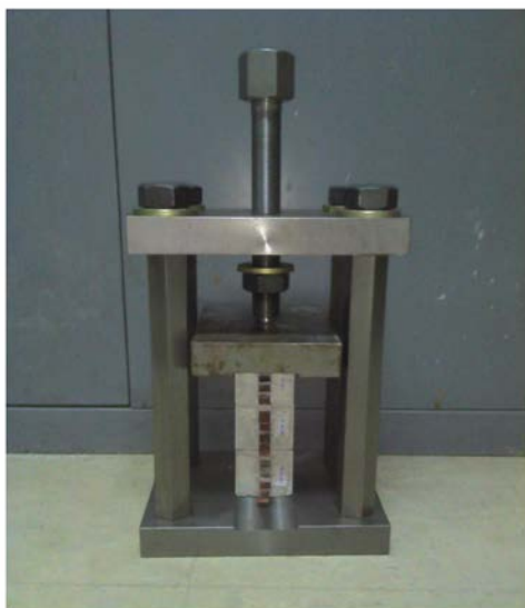
รูปที่ 3-7 เครื่องกดแบบ Sustained Load
