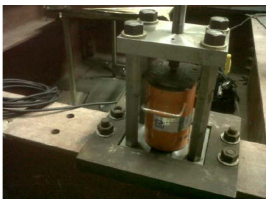
รูปที่ 3-14 รูปการนำ Load Cell ไปวางไว้ในแท่นกดของเครื่องกดแบบคงค้ำ
