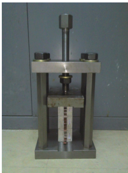
รูปที่ 3-24 ภาพการกดก้อนซีเมนต์เบสเซ็นเซอร์ด้วยเครื่องกดแบบคงค้ำ
