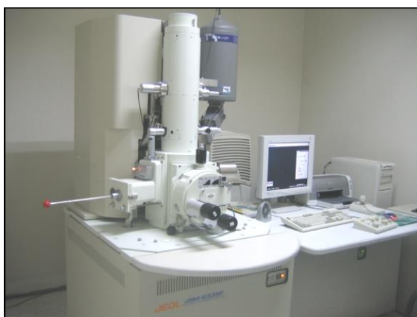
รูปที่ 3.18 Field emission-scanning electron microscope (FESEM, JSM-6335F) ของบริษัท JEOL ที่มีการติดตั้งชุด Energy Dispersive Spectrometry (EDS)
