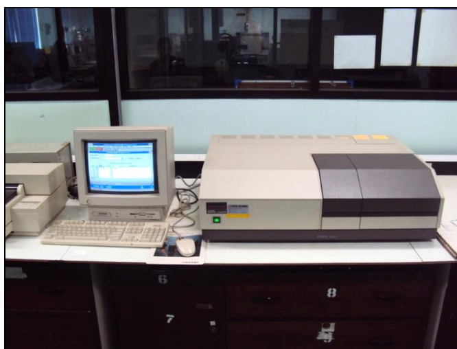
รูปที่ 3.23 เครื่อง UV-Vis-NIR Spectrophotometer, Lambda 19 Perkin Elmer (ภาควิชาเคมี คณะวิทยาศาสตร์ มหาวิทยาลัยเชียงใหม่)
