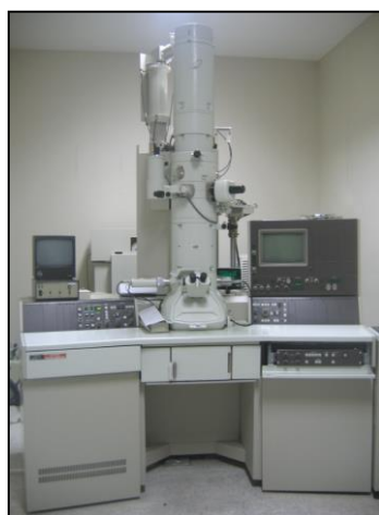
รูปที่ 3.20 TEM รุ่น JSM-2010 ของบริษัท JEOL ที่ติดตั้ง ณ ศูนย์บริการวิทยาศาสตร์และเทคโนโลยี คณะวิทยาศาสตร์ มหาวิทยาลัยเชียงใหม่ (ศวท-มช.)
