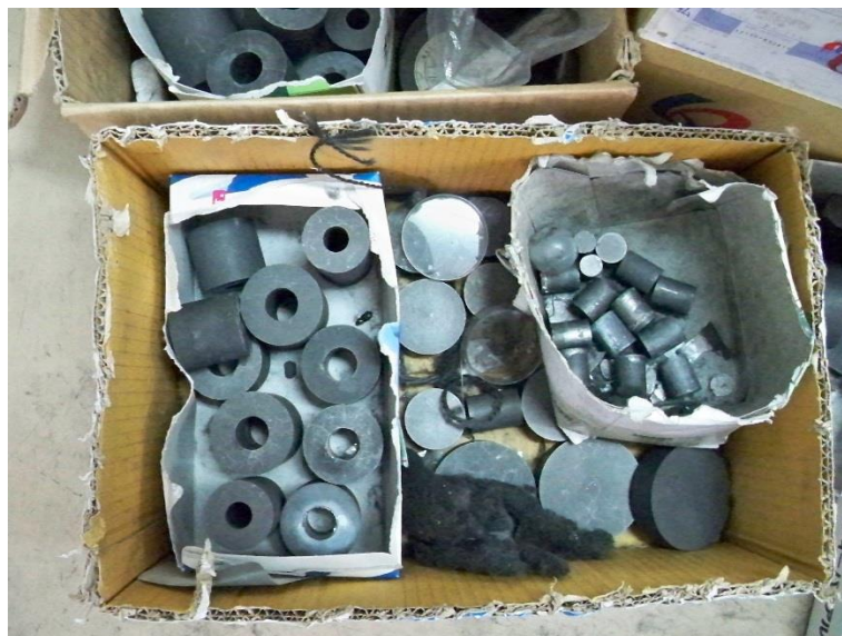
รูปที่ 3.2 ตัวอย่างแม่พิมพ์แกรไฟต์ (graphite die) ขนาดต่างๆ
