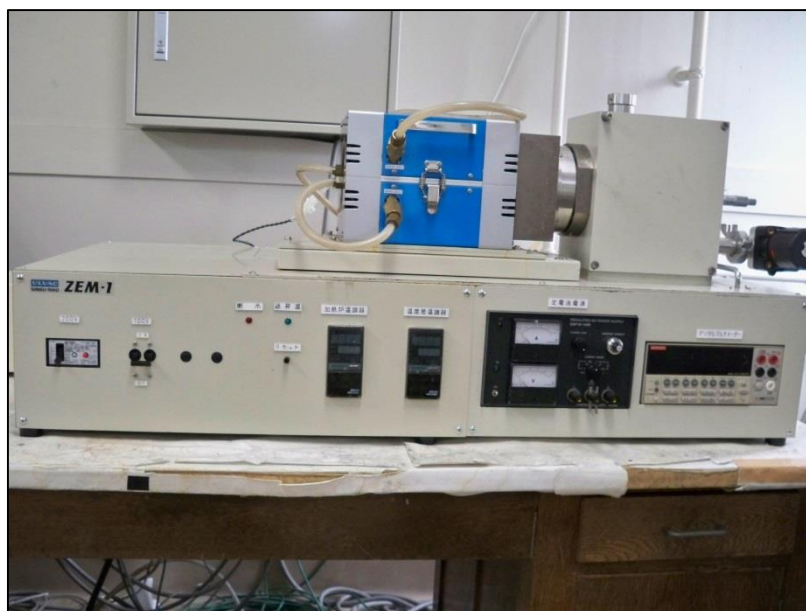
รูปที่ 3.27 เครื่องมือวัดค่าสภาพต้านทานไฟฟ้าและค่าสัมประสิทธิ์ซีเบค ULVAC ZEM-1 บริษัท ULVAC-RIKO ประเทศญี่ปุ่น (Yamanaka Lab, Osaka university, Japan)
