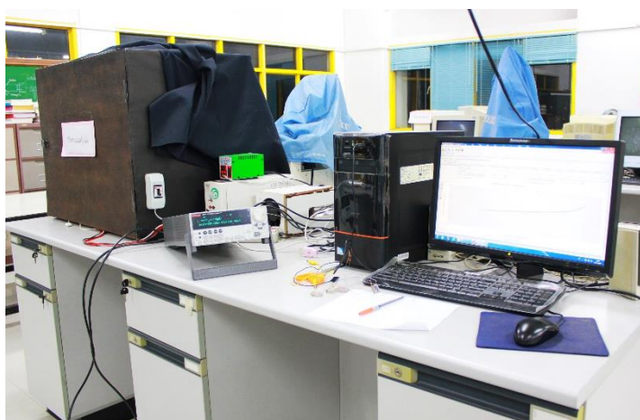
รูปที่ 3.14 ชุดวัดประสิทธิภาพการแปลงพลังงานของเซลล์แสงอาทิตย์ (หน่วยวิจัยการแปลงพลังงานและวิทยาศาสตร์นาโน ภาควิชาฟิสิกส์และวัสดุศาสตร์ คณะวิทยาศาสตร์ มหาวิทยาลัยเชียงใหม่)
