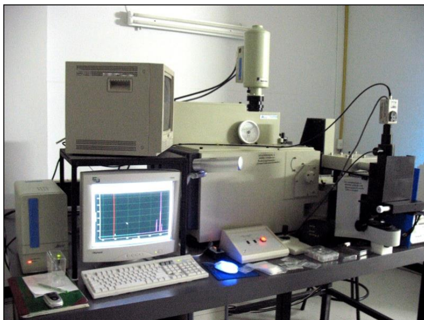
รูปที่ 3.21 เครื่อง Raman spectroscopy ของบริษัท Horiba Jobin Yvon, รุ่น T6400JY ที่ติดตั้ง ณ ศูนย์บริการวิทยาศาสตร์และเทคโนโลยี คณะวิทยาศาสตร์ มหาวิทยาลัยเชียงใหม่ (ศวท-มช.)
