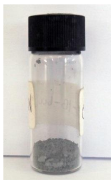
รูปที่ 3.1 ผงผลึก CAO ที่ได้จากการสังเคราะห์ด้วยคลื่นไมโครเวฟ (600 W และ 20 นาที)
