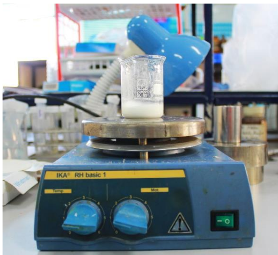
รูปที่ 3.8 การเตรียมส่วนผสม \text{TiO}_2 สำหรับเป็นชั้นสารกึ่งตัวนำออกไซด์ของขั้วแอโนด
