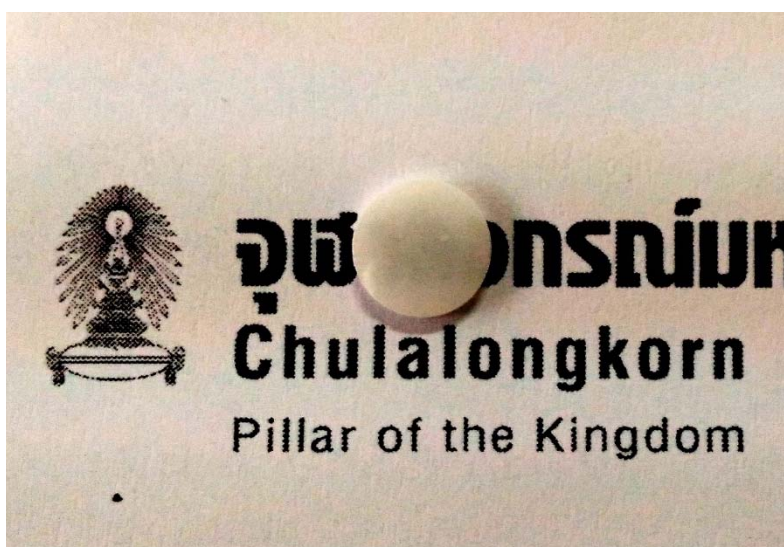
รูปที่ 4.86 ลักษณะชิ้นงานแมกนีเซียมอะลูมิเนียมไฮดรอกไซด์เซรามิกที่ผ่านการอัดร้อนที่อุณหภูมิ 1500 องศาเซลเซียส ด้วยแรงดัน 200 เมกะพาสคัลเป็นเวลา 2 ชั่วโมง
