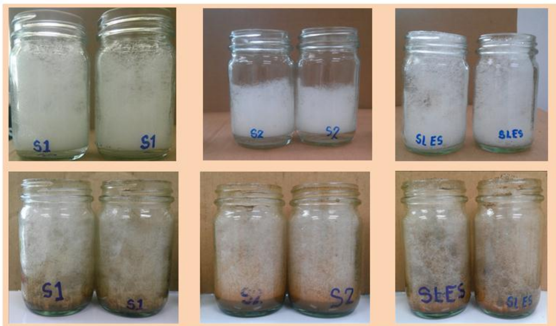
รูปที่ 35 การวัดการสลายตัวเปลี่ยนสถานะ จากสถานะโฟมกลายเป็นสถานะของเหลว ที่ระยะเวลา 30 นาที
