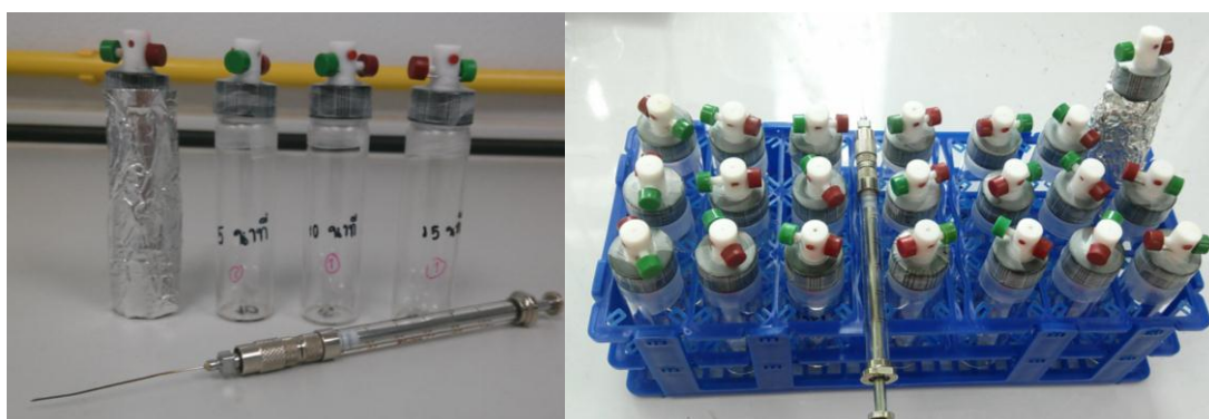
รูปที่ 30 ขวดการทดลองสำหรับการประเมินความสามารถของอนุภาค NZVI ที่ถูกปรับเสถียรภาพด้วยโพลีเมอร์ในการกำจัดสาร TCE
