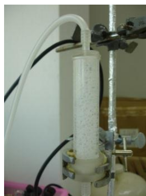
รูปที่ 19 Foam Generation Column
