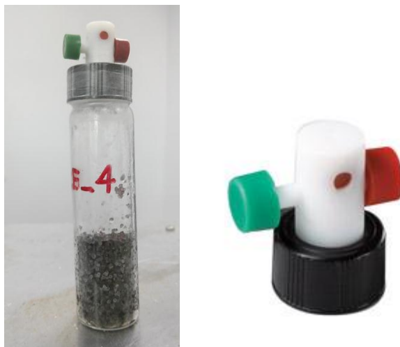
รูปที่ 30 ขวดการทดลองสำหรับการประเมินความสามารถของอนุภาค NZVI ที่ถูกปรับเสถียรภาพด้วยโพลีเมอร์ในการกำจัดสาร TCE
