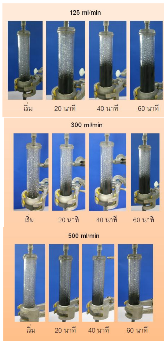
รูปที่ 46 การเป่าสร้างโฟมที่อัตราการไหลแก๊สออกซิเจน 125 300 และ 500 มล./นาที่
