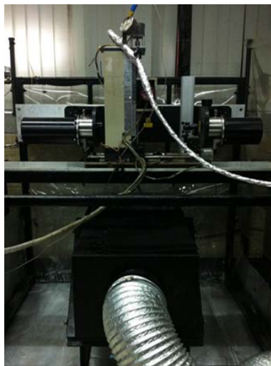
รูปที่ 3-5 แสดงวัดขนาดอนุภาคด้วย Malvern Spraytec
