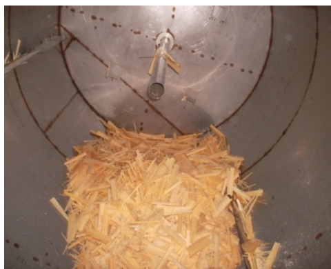
รูปที่ 2.2 แสดงลักษณะแถบไม้ที่เตรียมได้ในขณะอบใน rotary drum oven
