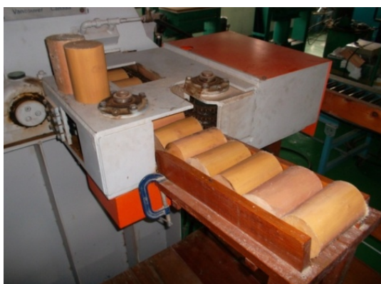
รูปที่ 2.1 แสดงลักษณะของท่อนไม้สดกลมที่กำลังป้อนเข้าสู่เครื่อง disc flaker
