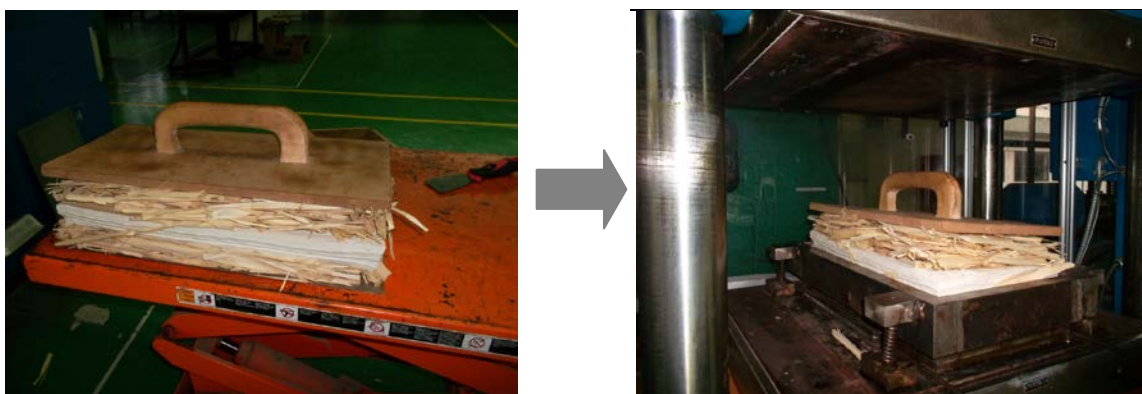
รูปที่ 2.5 ลักษณะของ blank ที่ประกอบด้วยชั้นแถบไม้ประกบชั้นยางคอมพาวด์แกนกลางและในขณะ blank อยู่ในแบบพิมพ์
