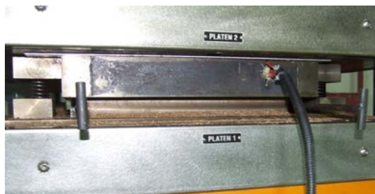
รูปที่ 2.4 ลักษณะของแบบพิมพ์ที่สร้างขึ้นเพื่อใช้ในงานวิจัยขณะติดตั้งกับเครื่องอัดไฮโดรลิก ก) ขณะเปิด ข) ขณะปิด
