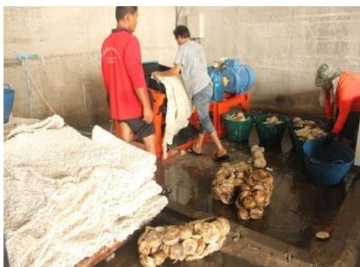
รูปที่ 3.12 การแปรรูปยางเครพ บริษัทเชียงรายยางพาราเซนเตอร์ จำกัด
