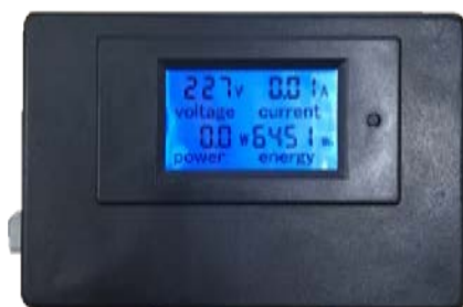
รูปที่ 3.7 เครื่องมือวัดกำลังไฟฟ้า
