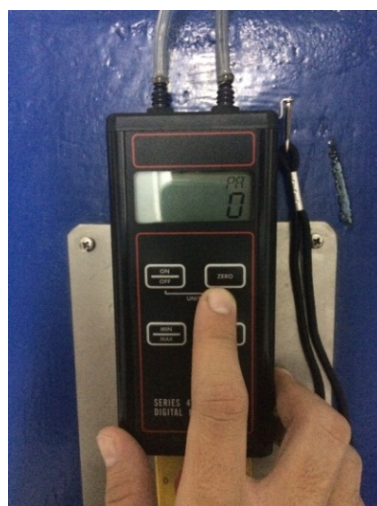
รูปที่ 3.18 ติดตั้งมาโนมิเตอร์เข้ากับสายวัดผลต่างความดัน
