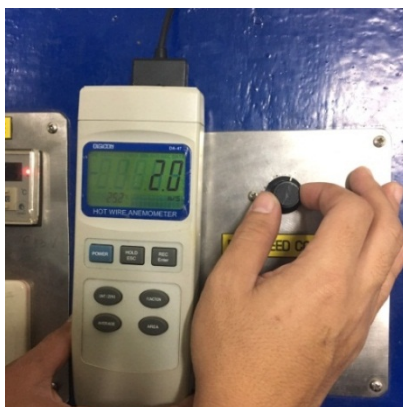
รูปที่ 3.21 ปรับความเร็วพัดลมตามที่กำหนด
