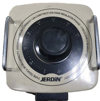
รูปที่ 3.2 อุปกรณ์ปรับแรงดันไฟฟ้า
