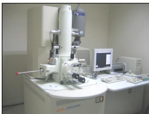
รูปที่ 3.13 Field emission-scanning electron microscope (FESEM, JSM-6335F) ของบริษัท JEOL ที่มีการติดตั้งชุด Energy Dispersive Spectrometry (EDS)
