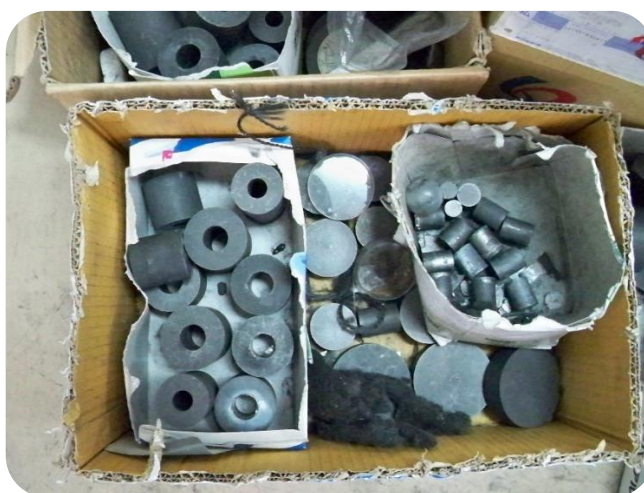
รูปที่ 3.2 ตัวอย่างแม่พิมพ์แกรไฟต์ (graphite die) ขนาดต่างๆ
