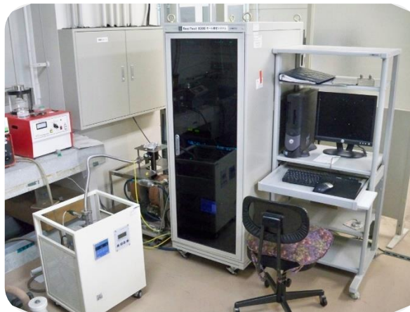
รูปที่ 3.19 เครื่องมือวิเคราะห์ปรากฏการณ์ฮอลล์ (Hall effect measurement) ของ Toyo Resitest 8300, Japan
