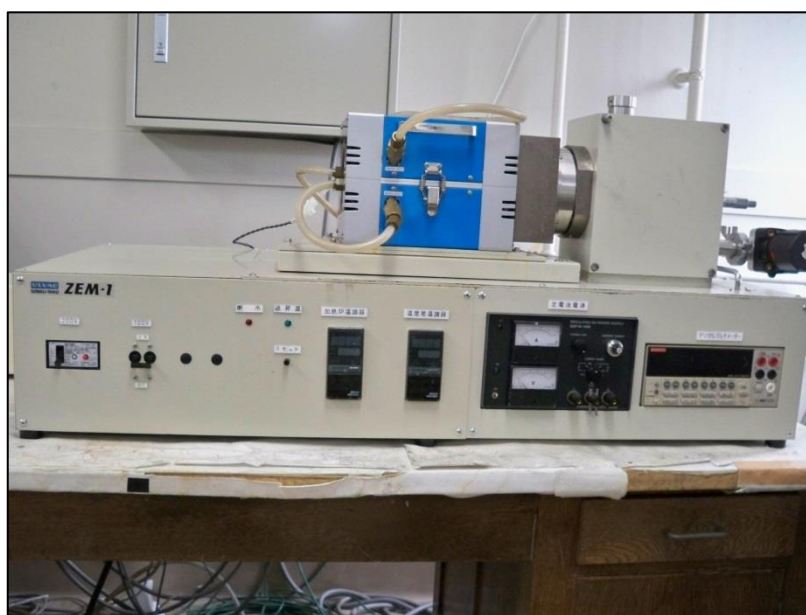
รูปที่ 3.15 เครื่องมือวัดสภาพต้านทานไฟฟ้าและสัมประสิทธิ์ซีเบค ULVAC ZEM-1 บริษัท ULVAC-RiKO ประเทศญี่ปุ่น (Yamanaka Lab, Osaka university, Japan)
