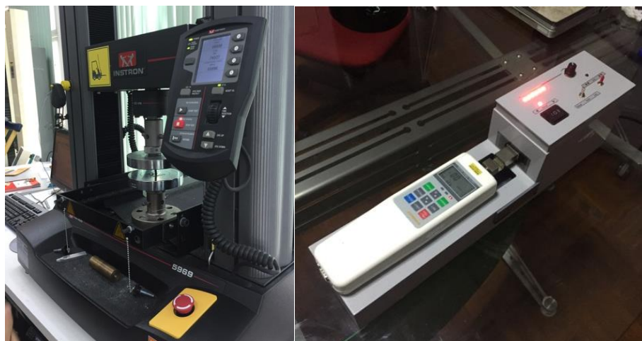
รูปที่ 6 เครื่อง Universal testing machine (ซ้าย) และเครื่องทดสอบความแข็งแรง (ขวา)
