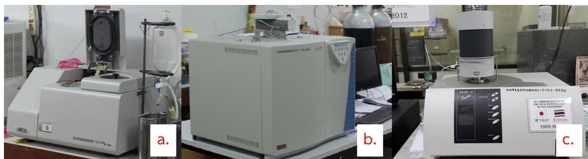
รูปที่ 4 เครื่องมือ a. Bomb calorimeter b. Elemental analyzer c. Simultaneous Thermal Analyzer
