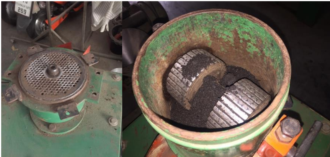
รูปที่ 5 เครื่องอัดแบบหัวแบบราบ ที่ใช้ในการผลิตเม็ดเชื้อเพลิง
