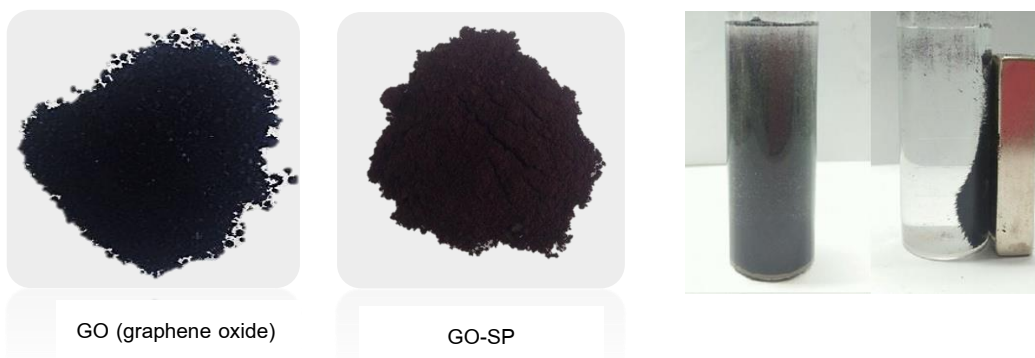
รูปที่ 2 ลักษณะทั่วไปของกราฟีนออกไซด์ (GO) และตัวกลางดูดซับกราฟีนออกไซด์ที่มีคุณสมบัติแม่เหล็ก (ชนิด GO-SP ) ที่สังเคราะห์ได้ในห้องปฏิบัติการ และประสิทธิภาพในการแยกออกจากน้ำด้วยแท่งแม่เหล็ก
