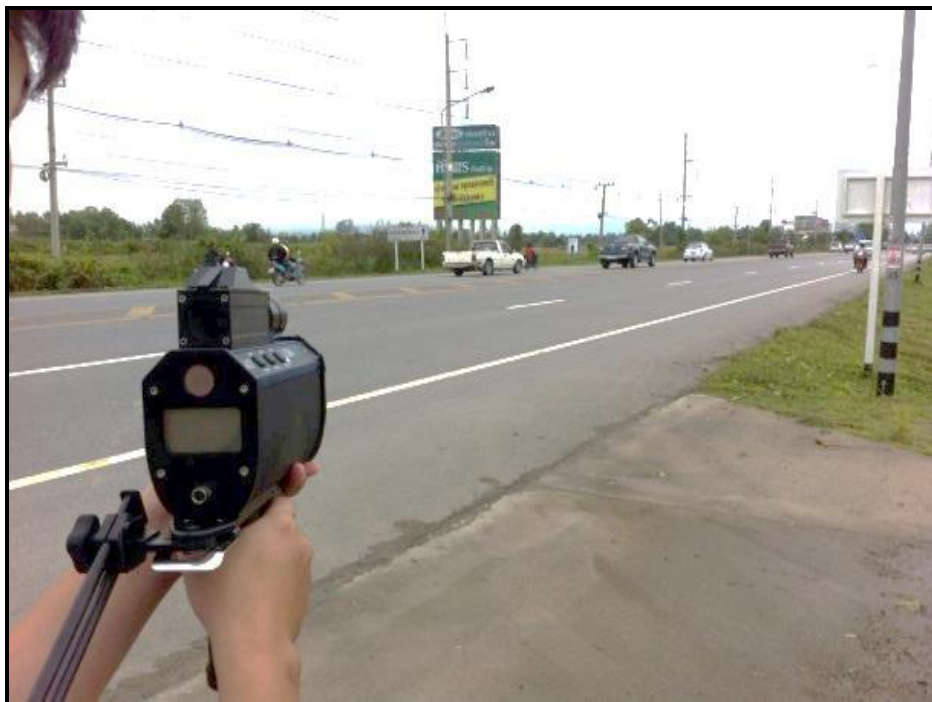
รูปที่ 3.2-4 ตัวอย่างการสำรวจความเร็วบนถนนสายหลัก
