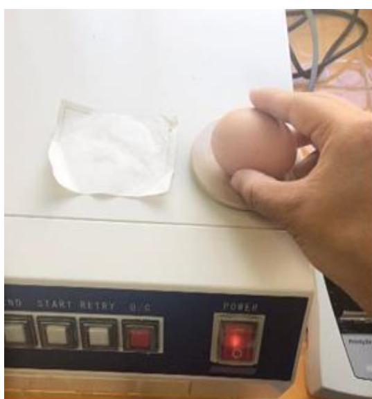
ภาพผนวกที่ 9 การวัดคุณภาพของไข่ด้วย เครื่อง egg multi tester
