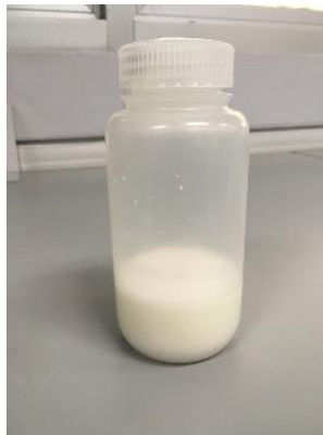
รูปที่ 2 เจลของซีโอไลต์ LSX ในขวดโพลีโพรพิลีน
