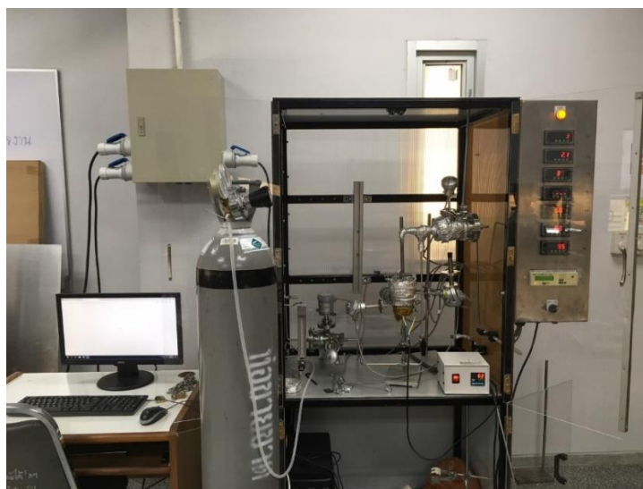
รูปที่ 8 ชุดทดสอบการกักเก็บพลังงานความร้อนในขั้นตอนการสะสมพลังงาน (charging)
