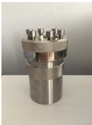
รูปที่ 3 เตาปฏิกรณ์หรือออตเคลฟทำจากวัสดุสแตนเลสที่มีภาชนะเทพลอนบรรจุอยู่ภายใน ใช้ในการสังเคราะห์โมเลกุลลาร์ซีฟ SAPO-11
