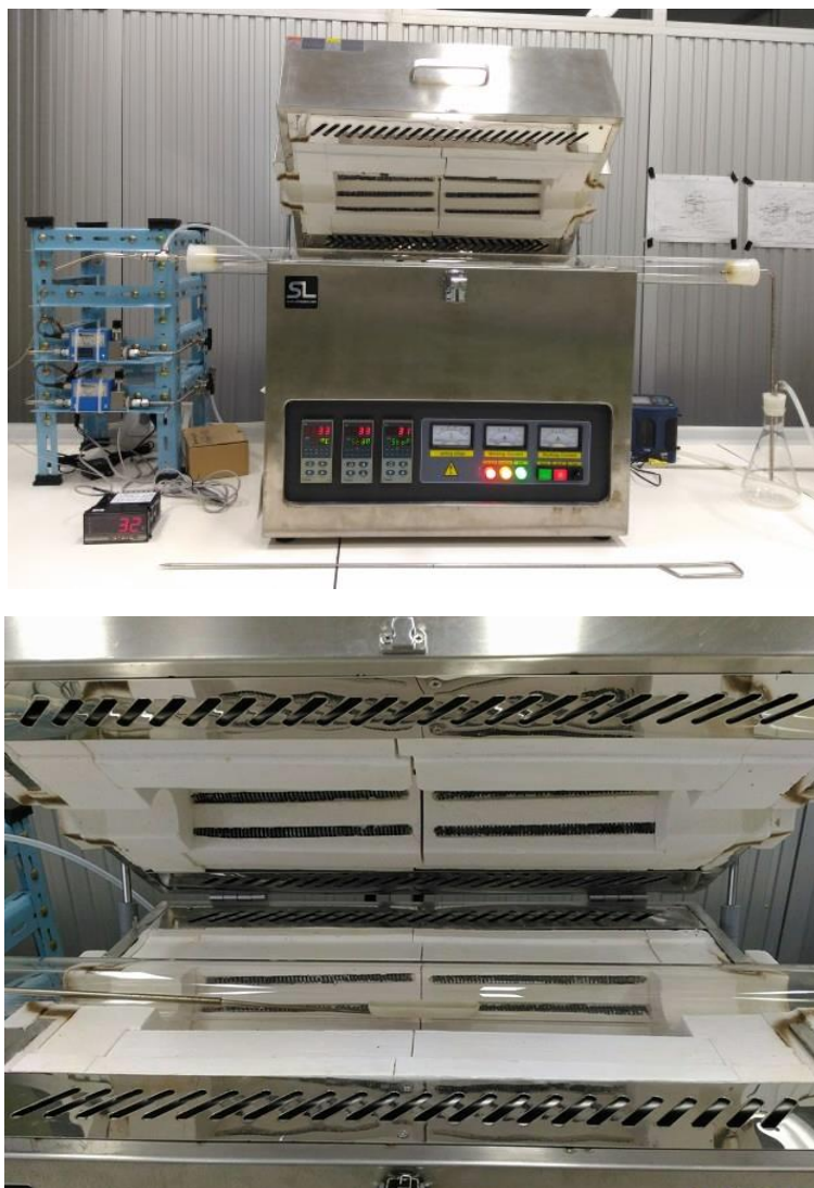
รูปที่ 2.3 ชุดท่อปฏิกิริยาและเตาเผาไฟฟ้าสำหรับการทำทอริแฟคชันของชีวมวล
