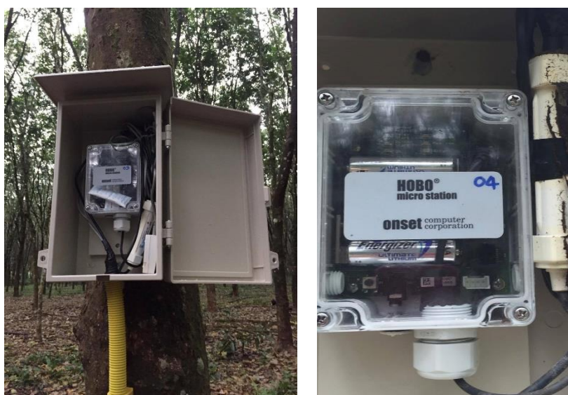
ภาพที่ 3.7 ชุดตรวจวัดปริมาณน้ำในดินเพื่อเป็นตัวแทนข้อมูลปริมาณน้ำในดินในพื้นที่แปลงศึกษา พร้อมระบบบันทึกข้อมูล
