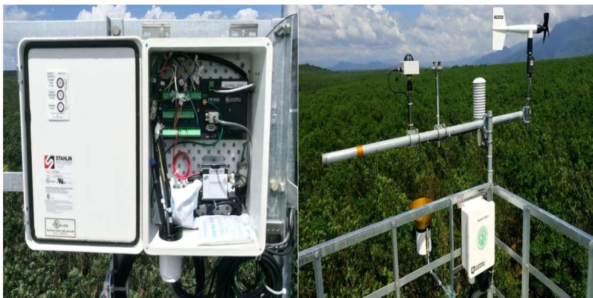
ภาพที่ 3.5 ชุดอุปกรณ์ตรวจวัดสภาพอุตุนิยมวิทยาเฉพาะพื้นที่ที่ถูกติดตั้งบนหอคอย พร้อมระบบบันทึกข้อมูล (Data logger) ณ. องค์การสวนยาง อำเภอนาบอน จังหวัดนครศรีธรรมราช ภาพถ่ายโดย ชมพูนุช ฉายาเวช
