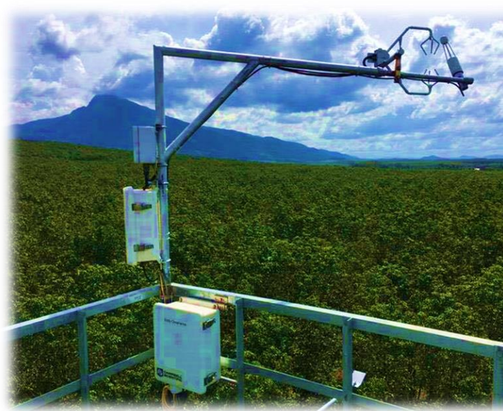
ภาพที่ 3.4 ชุดอุปกรณ์ Eddy Covariance แบบถาวรบนหอคอย ณ แปลงยางพารา ภายในพื้นที่รับผิดชอบขององค์การสวนยาง อำเภอนาบอน จังหวัดนครศรีธรรมราช ภาพถ่ายโดย ชมพูนุช ฉายาเวช
