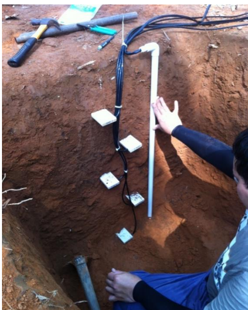
ภาพที่ 3.6 ชุดตรวจวัดปริมาณน้ำในดินและอุณหภูมิดิน พร้อมระบบบันทึกข้อมูล (Data logger)
