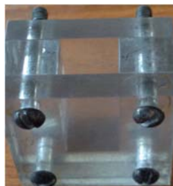
รูปที่ 2 แม่พิมพ์อะคริลิกที่ใช้ในการขึ้นรูปขั้วสังกะสีที่มีอีพอกซีโพลีเมอร์เชื่อมประสาน ปริมาตร 1 \times 2 \times 0.4 ลูกบาศก์เซนติเมตร
