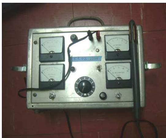
รูปที่ 4 แสดงอุปกรณ์ชนิด Electroejaculator ใช้เพื่อสำหรับการเก็บตัวอสุจิจากเสีอลายเมฆ
