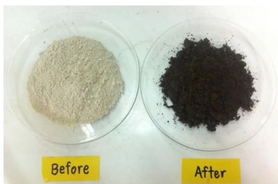
รูป 2.3 ลักษณะทางกายภาพของดินฟอกสี (ซ้าย) และกากดินฟอกสี (ขวา)
