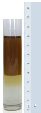
รูป 3.1 การวัดความสูงของแต่ละวัฏภาคในการเกิดไมโครอิมัลชัน
