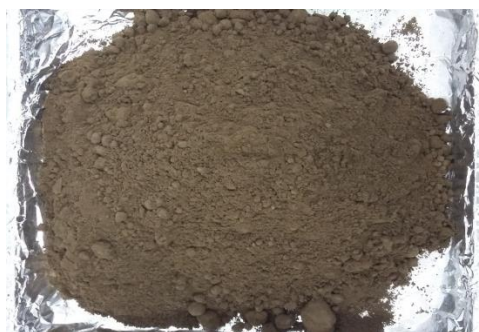
รูป 3.3 ลักษณะทางกายภาพของกากดินฟอกสีที่ผ่านกระบวนการปรับปรุงคุณภาพน้ำมันรำข้าวดิบ
