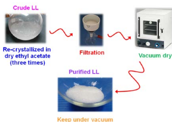
รูปที่ 2 กระบวนการทำนอเมอร์ LL ให้บริสุทธิ์โดยการตกผลึก การกรอง และการอบภายใต้สภาวะสุญญากาศ
