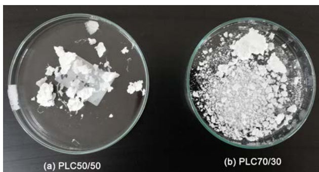
รูปที่ 29 พอลิ(แอล-แลกไทด์-โค-เอป/ไซลอน-คาโพรแลกโตน) ชนิดบริสุทธิ์ที่สังเคราะห์จาก ROP ของ LL และ \epsilon -CL ที่ริเริ่มโดยตัวริเริ่ม SnLL4 เข้มข้น 0.100 %w/w ณ อุณหภูมิ 150 °C เวลา 48 ชั่วโมง: (a) PLC50/50 และ (b) PLC70/30
