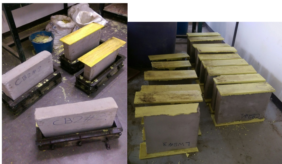
รูปที่ 3.8 การแคปตัวอย่างทดสอบชิ้นส่วนผนังก่ออิฐก่อและหลังถอดออกจากแบบ
