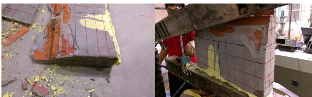
รูปที่ 3.25 ลักษณะการวิบัติของชิ้นส่วนผนังก่ออิฐมวลูนชนิดที่ 6 (CB6)
