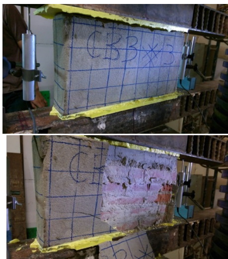
รูปที่ 3.13 การทดสอบกำลังอัดของตัวอย่างทดสอบชิ้นส่วนผนังก่ออิฐก่อนและหลัง
