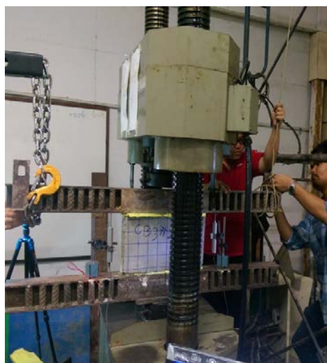
รูปที่ 3.12 การติดตั้งตัวอย่างทดสอบชิ้นส่วนผนังก่ออิฐกับเครื่องมือทดสอบ
