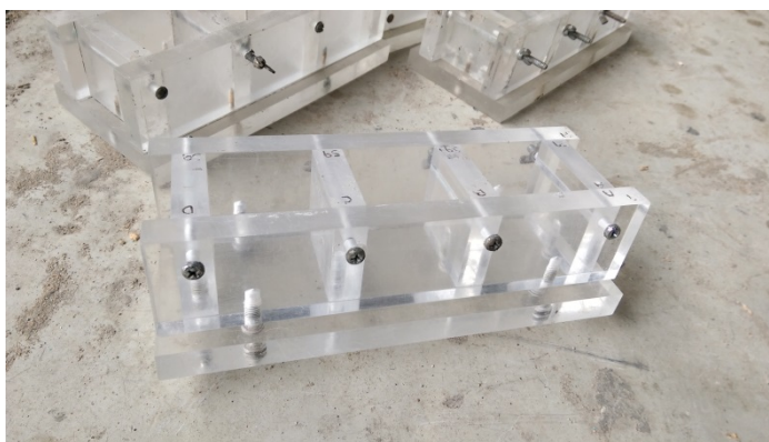
รูปที่ 3.4 แบบหล่อตัวอย่างที่ใช้ในการเก็บตัวอย่างมอร์ตาร์
