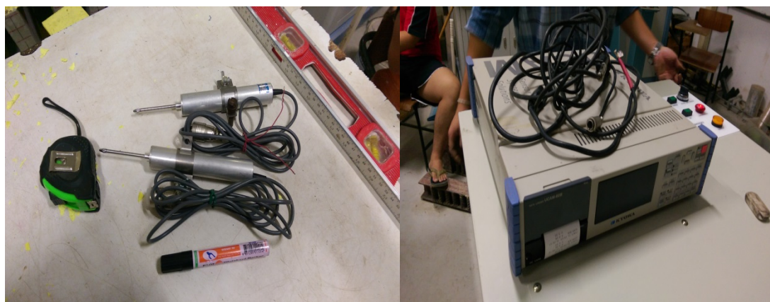
รูปที่ 3.11 เครื่องมือ LVDT และ Data Logger ที่ใช้ในการทดสอบ
