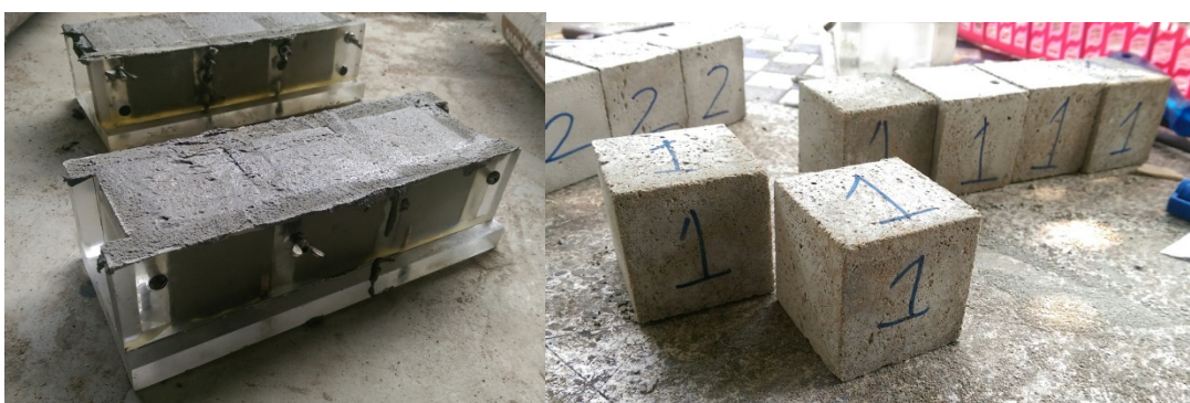
รูปที่ 3.5 การเก็บตัวอย่างมอร์ตาร์ก่อนและหลังถอดแบบ
