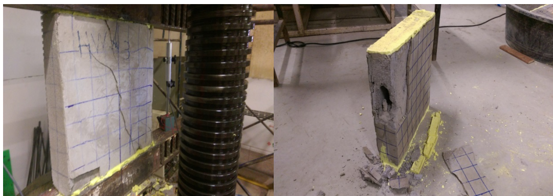
รูปที่ 3.27 ลักษณะการวิบัติของชิ้นส่วนผนังก่ออิฐบล็อก (HB)
