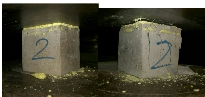
รูปที่ 3.9 การทดสอบกำลังอัดตัวอย่างมอร์ตาร์
