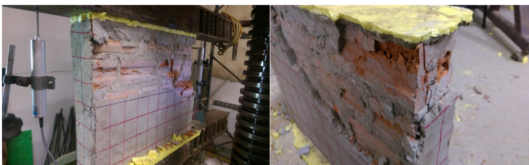
รูปที่ 3.17 ลักษณะการวิบัติของชิ้นส่วนผนังก่ออิฐมวลเบาชนิดที่ 2 (CB2)
