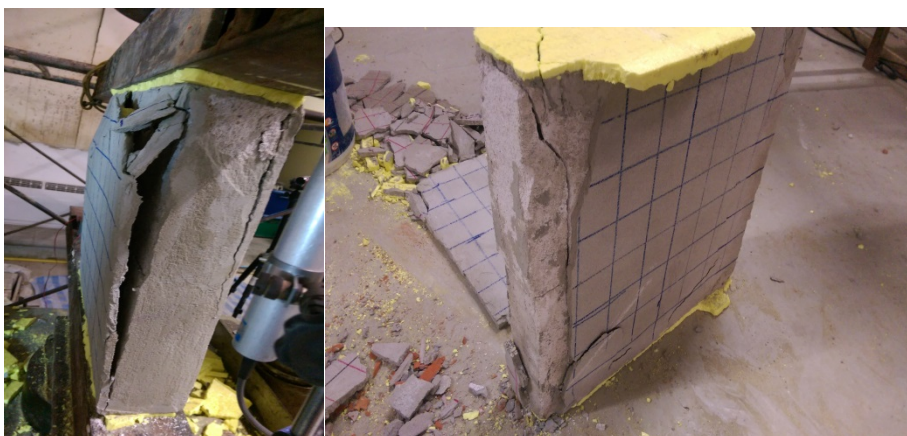
รูปที่ 3.29 ลักษณะการวิบัติของชิ้นส่วนผนังก่ออิฐมวลเบา (LWB)
