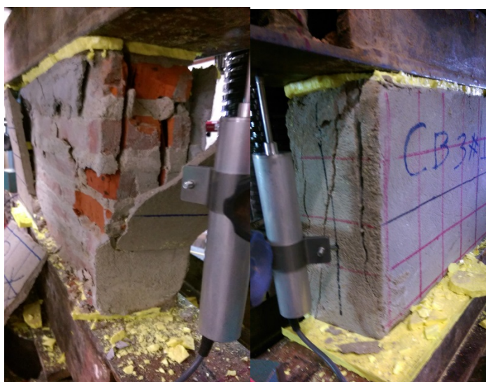
รูปที่ 3.19 ลักษณะการวิบัติของชิ้นส่วนผนังก่ออิฐมวลูนชนิดที่ 3 (CB3)
