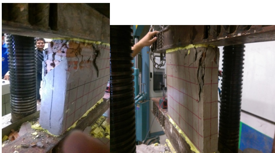
รูปที่ 3.15 ลักษณะการวิบัติของชิ้นส่วนผนังก่ออิฐมวลูนชนิดที่ 1 (CB1)
