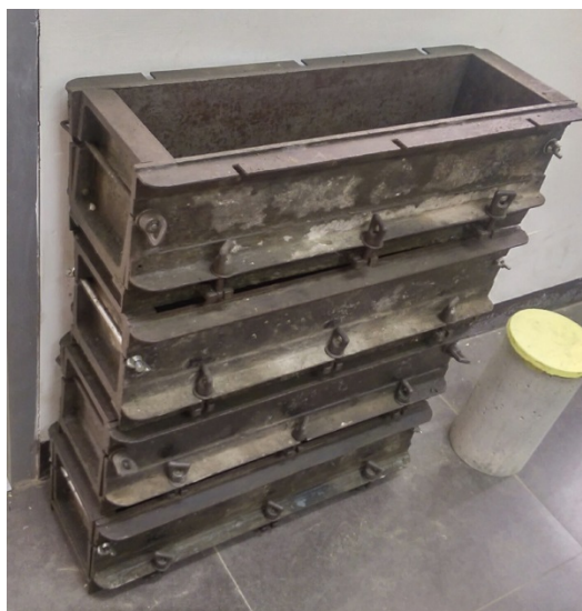
รูปที่ 3.7 แบบหล่อตัวอย่างที่ใช้ในการแคปตัวอย่างทดสอบชิ้นส่วนผนังก่ออิฐ
