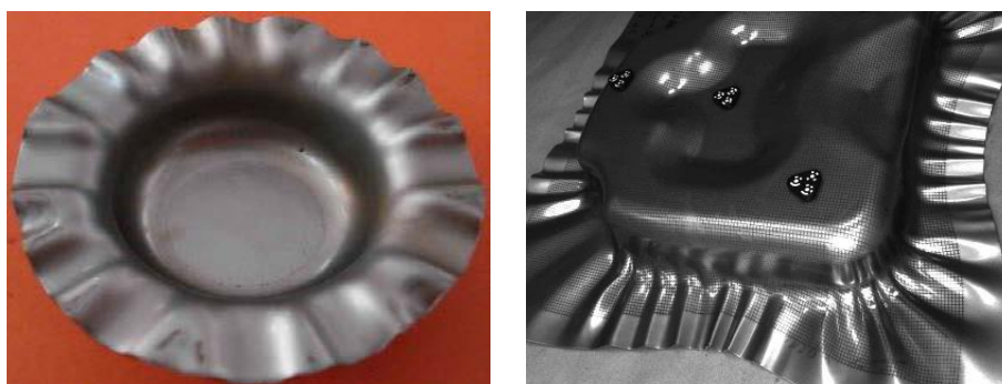
ภาพที่ 2-33 การเกิดการยุบบนปีกถ้วยของขึ้นรูป และการทดสอบการขึ้นรูปลึกแบบสี่เหลี่ยม [25]
