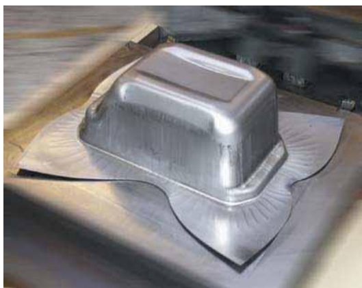
ภาพที่ 1-2 การเกิดการย่นบนโลหะแผ่นในกระบวนการขึ้นรูป [5]
