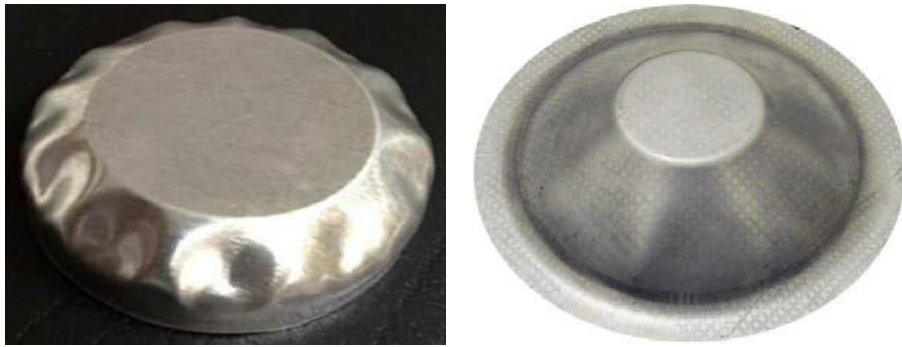
ภาพที่ 2-34 การเกิดการย่นด้านข้างผนังของทดลองการขึ้นรูปลึกทรงกระบอก และทรงกรวย [6]
