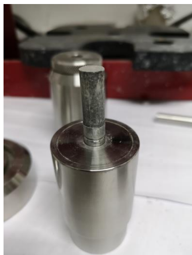
รูปที่ 4.2 ตัวอย่างชิ้นงานที่ทำการขึ้นรูปด้วยเครื่องอัดไฮดรอลิกสำหรับการทดสอบค่ากำลังอัด
