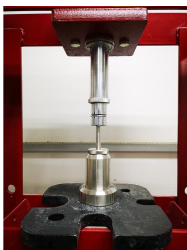
รูปที่ 4.1 แสดงการอัดขึ้นรูปชิ้นงานด้วยเครื่องอัดไฮดรอลิกสำหรับการทดสอบค่ากำลังอัด
