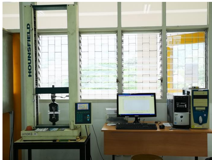
รูปที่ 4.5 แสดงการทดสอบหาค่ากำลังอัดของวัสดุผสม
