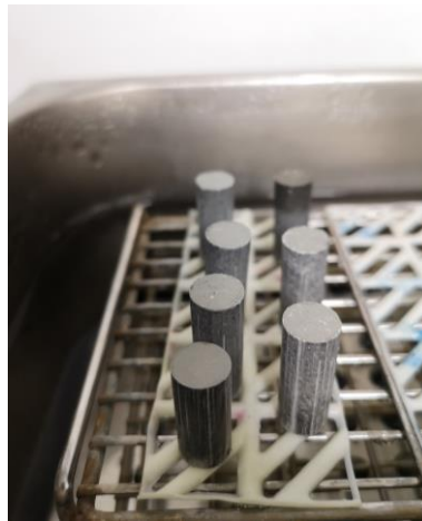
รูปที่ 4.4 ตัวอย่างชิ้นงานในเครื่องควบคุมอุณหภูมิ 60 องศาเซลเซียส ในสถานะที่มีความชื้นสัมพัทธ์ 98%
