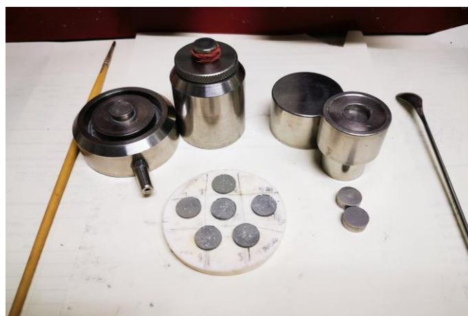
รูปที่ 4.6 ตัวอย่างชิ้นงานที่ทำการขึ้นรูปด้วยเครื่องอัดไฮดรอลิกสำหรับศึกษาสมบัติเพอร์โรอิเล็กทริก
