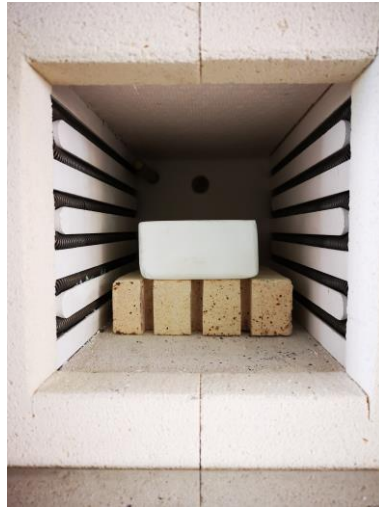
รูปที่ 4.3 ตัวอย่างการอบชิ้นงานที่อุณหภูมิ 170 องศาเซลเซียส
