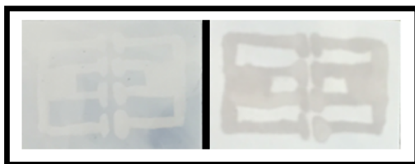
รูปที่ 12 แสดง \text{SiO}_2 ที่ถูกเคลือบด้วย ZnO โดยด้านซ้ายยังไม่ได้ผ่านการเผา และด้านขวาผ่านการเผาด้วยอุณหภูมิ 400 องศาเซลเซียส เป็นเวลา 2 ชั่วโมง
