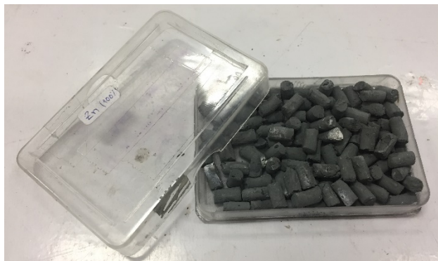
รูปที่ 10 แสดงแท่ง Zn ที่เผาด้วยอุณหภูมิ 400 องศาเซลเซียส เป็นเวลา 10 ชั่วโมง
