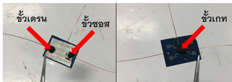
รูปที่ 13 แสดง \text{SiO}_2 ที่ติดขั้วโดยด้านซ้ายคือ ขั้วเดรนและขั้วซอร์ส และด้านขวาคือขั้วเกต
