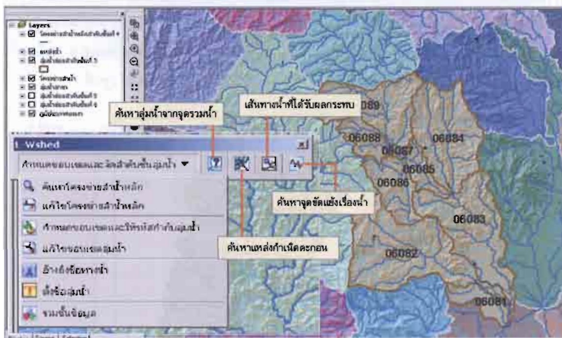
รูปที่ 7-12 ชุดเครื่องมือกำหนดขอบเขตและจัดลำดับชั้นลุ่มน้ำด้วยระบบ Pfafstetter และชุดเครื่องมือวิเคราะห์เครือข่ายลุ่มน้ำในโปรแกรม L-Wshed
