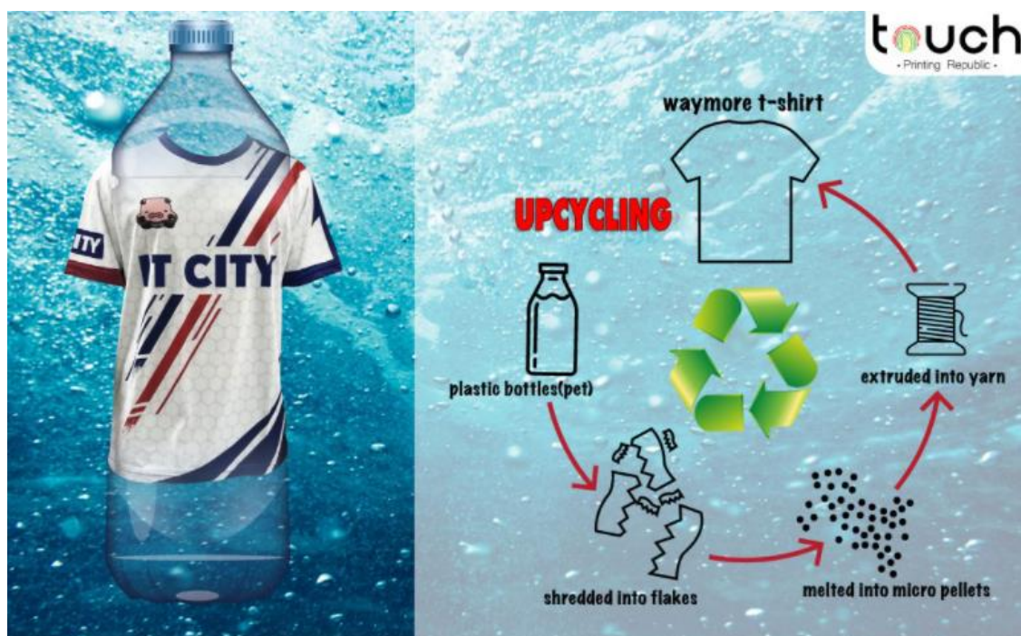
รูปที่ 4-21 กระบวนการผลิตเส้นใยโพลีเอสเตอร์จากขวดพลาสติกประเภท PET ที่ใช้แล้วของ บริษัท Touch-Printing Republic Co.,Ltd.
