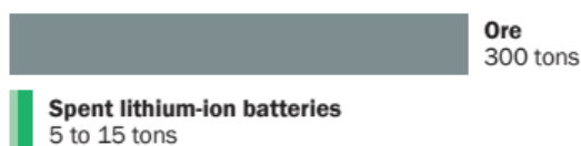
รูปที่ 4-48 Benefits of recycling for lithium-ion batteries [4-102]
