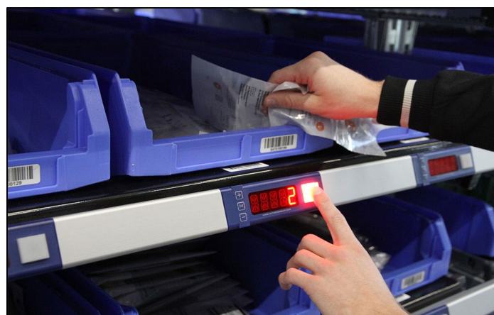
รูปภาพที่ 4-39 การหยิบสินค้าด้วยระบบ Pick-to-Light
