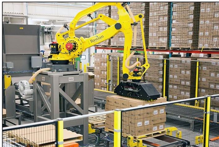
รูปภาพที่ 4-36 เครื่องจัดเรียงสินค้าหรือระบบจัดเรียงสินค้าลงพาเลทอัตโนมัติ
