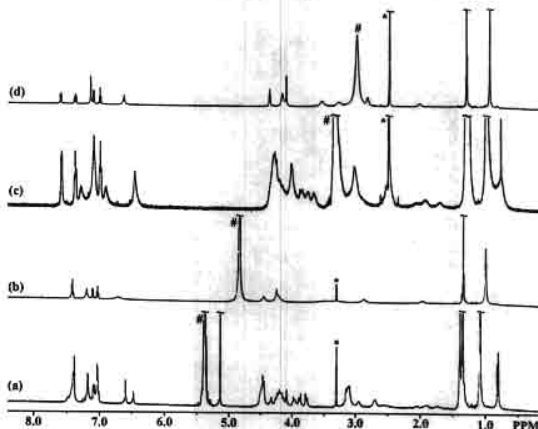
รูปที่ 5 ^1\text{H} NMR สเปกตรัมของสาร 10 (a) ใน \text{CD}_3\text{OD} ที่ -40 °C (b) ใน \text{CD}_3\text{OD} ที่ 27 °C (c) ใน \text{DMSO}-d_6 ที่ 27 °C และ (d) ใน \text{DMSO}-d_6 ที่ 100 °C. * และ # เป็นสัญญาณของน้ำและตัวทำละลายที่ใช้ตามลำดับ
