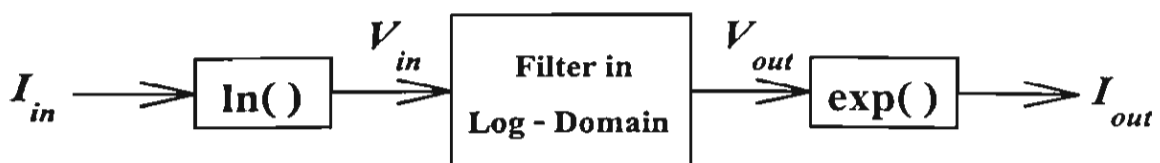
รูปที่ 2.6 บล็อกไดอะแกรมของวงจรกรองล็อกโดเมน
