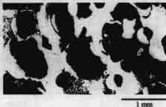
รูปที่ 4.92 ลักษณะเซลล์ของยางเบลนด์ระหว่างยางธรรมชาติกับยางมาลีเอตอีพีดีเอ็ม อบโดยใช้ไมโครเวฟ 2 นาที ร่วมกับตู้อบอากาศร้อน 8 นาที ที่อุณหภูมิ 180^{\circ}\text{C}
