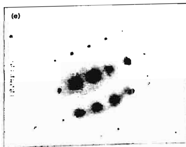
รูป 30 (a) -(d) คือภาพ bright field ของเหล็กหล่อ II แสดงอนุภาคที่มีอะลูมิเนียมสูงภายในเมทริกซ์เฟอร์ไรต์ (e) แบบรูปการเลี้ยวเบนที่ได้จากบริเวณ (1) ของรูป 30(d)
