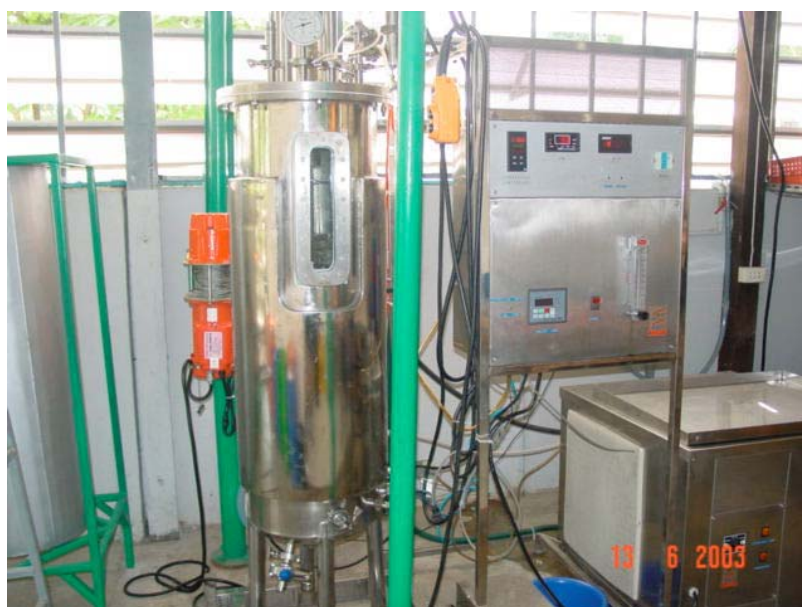
รูปที่ ค.2 ถังหมักขนาด 100L และแผงควบคุม
