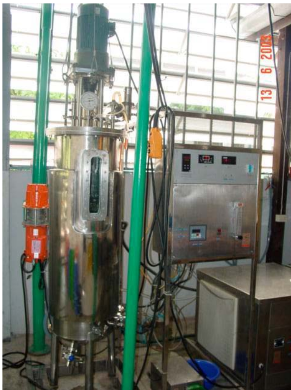
รูปที่ ค.5 ถังหมักขนาด 100L พร้อมมอเตอร์
