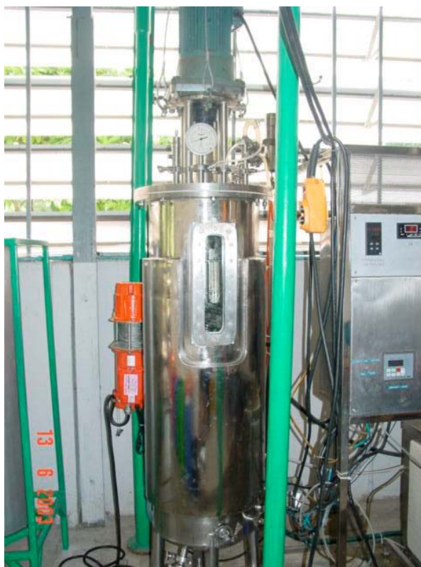
รูปที่ ค.1 ถังหมักขนาด 100L
