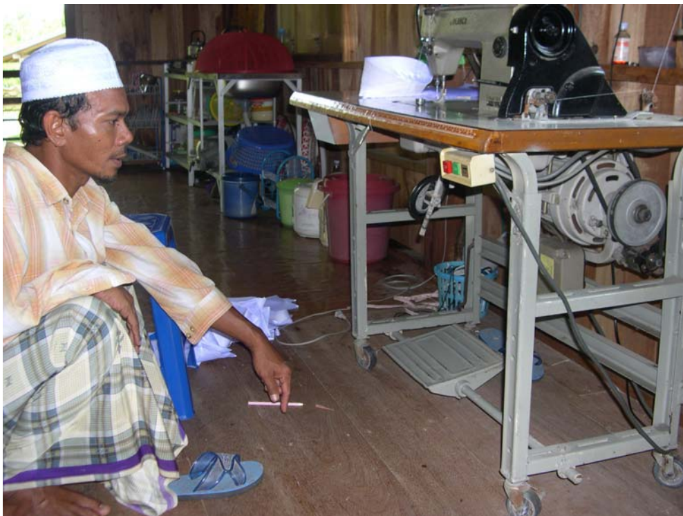
ภาพที่ 28 จักรอุตสาหกรรมสำหรับเย็บกะปิเยาะห์ ซึ่งส่วนใหญ่ไม่นิยมต่อสายดินเพื่อป้องกันไฟฟ้าดูด
