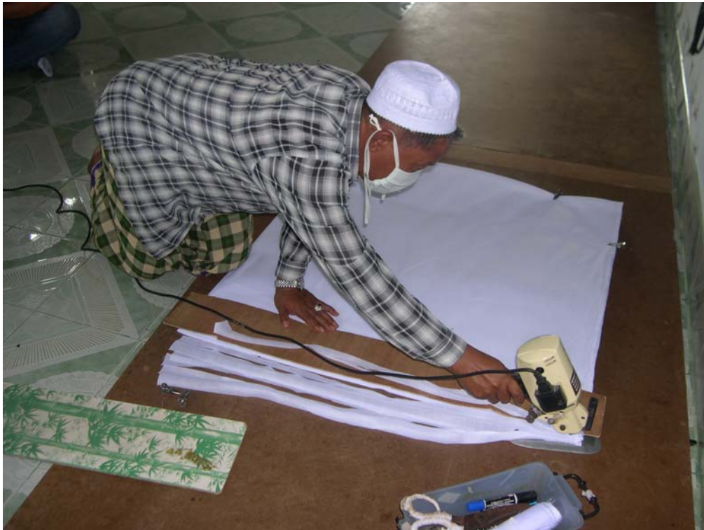
ภาพที่ 25 การตัดผ้าโดยใช้เครื่องตัดแบบไฟฟ้า
