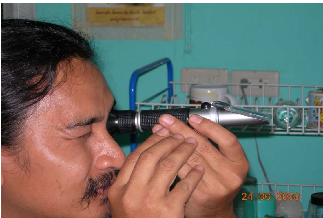
ภาพที่ 12 การวัดความหวาน (Total Soluble Solid)
