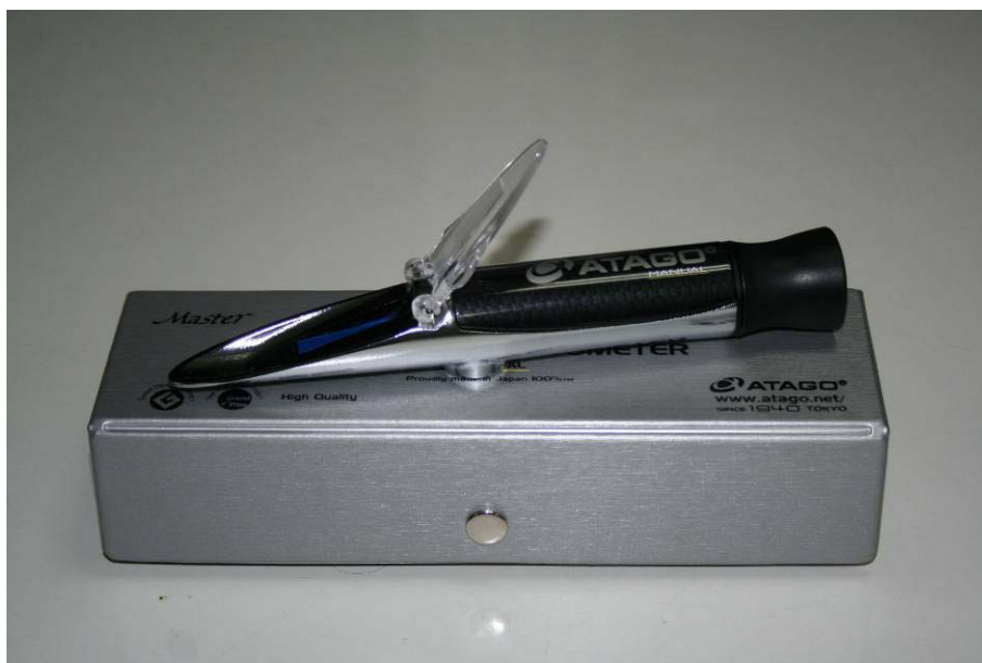
รูปที่ 5 เครื่องวัดความหวาน แบบ % Brix (Refractometer)
