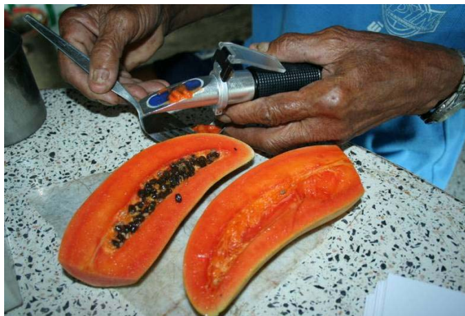
รูปที่ 6 การทดสอบความหวานมะละกอด้วย Hand Refractometer
