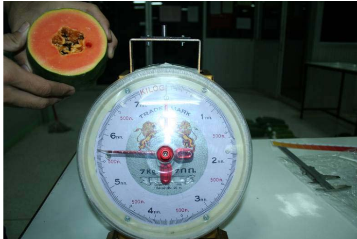
รูปที่ 41 การทดสอบความแน่นเนื้อของมะละกอสุกด้วยแท่งโลหะ ขนาด 8 มิลลิเมตร ที่ติดตั้งเข้ากับเครื่องชั่งแบบเข็ม
