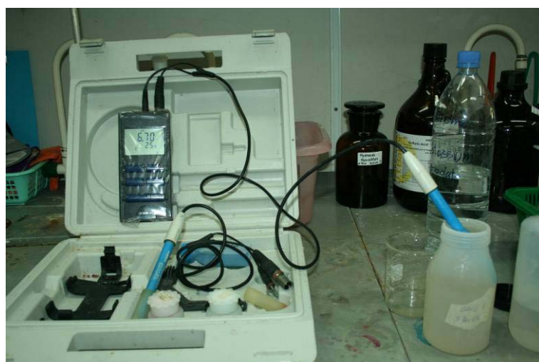
รูปที่ 25 การใช้ pH Meter เพื่อทดสอบความเป็นกรด - ด่างของน้ำ
