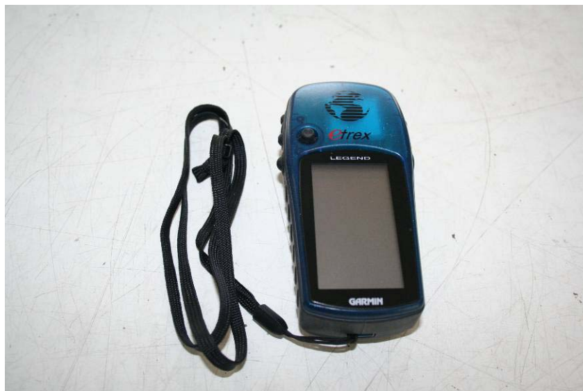
รูปที่ 11 เครื่องจีพีเอส (GPS) แบบนำหน ยี่ห้อ etrex รุ่น Legend
