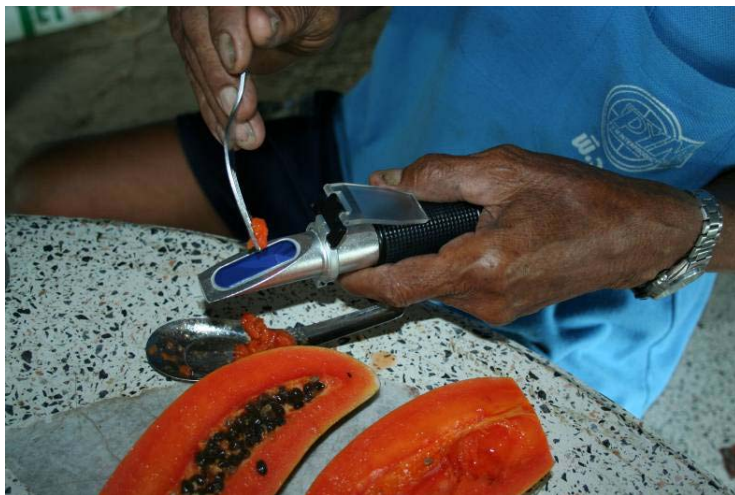
รูปที่ 4 การทดสอบความหวานของมะละกอที่ปลูกภายในมุ้งของเกษตรกรจังหวัดปทุมธานีด้วยเครื่องมือทดสอบความหวาน (Hand refractometer) ได้ผลการทดสอบเฉลี่ย เท่ากับ 13.5 %Brix ถึง 14.0 %Brix ซึ่งถือได้ว่า มีคุณภาพดี และจากการสอบถามเกษตรกรถึงเคล็ดลับในการปลูกระยะกอกก็ได้คำตอบว่า การจะปลูกระยะกอกให้มีความหวานนั้น จำเป็นต้องดูแลมะละกออย่างดีด้วยการรดน้ำ การใส่ปุ๋ยให้ถูกสูตรถูกเวลารวมทั้งความเหมาะสมของความเป็นกรด-ด่างในดิน ตลอดจนสายพันธุ์ของมะละกอ
