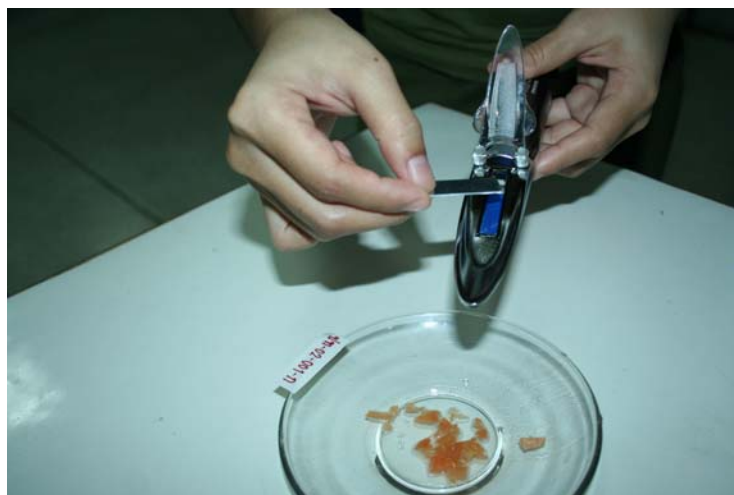
รูปที่ 42 การทดสอบความหวานของมะละกอสุกด้วยเครื่องมือวัดความหวาน (Hand refractometer)
