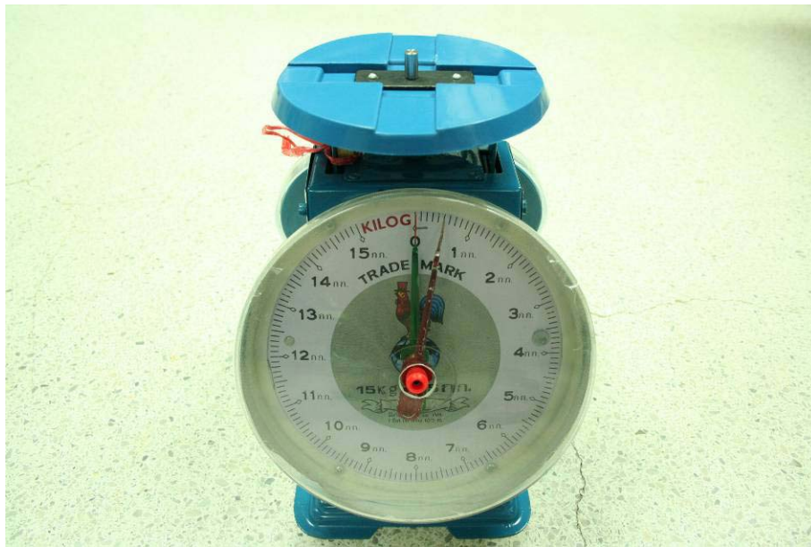
รูปที่ 6 เครื่องทดสอบความแน่นเนื้อ แบบหัวกดขนาดเส้นผ่านศูนย์กลาง 8 มิลลิเมตร
