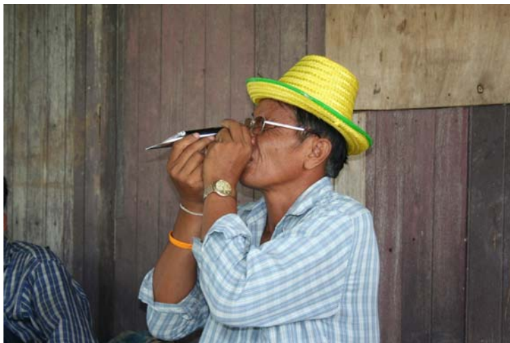
รูปที่ 26 การสอนความรู้เบื้องต้นในการใช้เครื่องมือวัดความหวาน (Hand refractometer) ให้แก่เกษตรกร ในจังหวัดปราจีนบุรี
