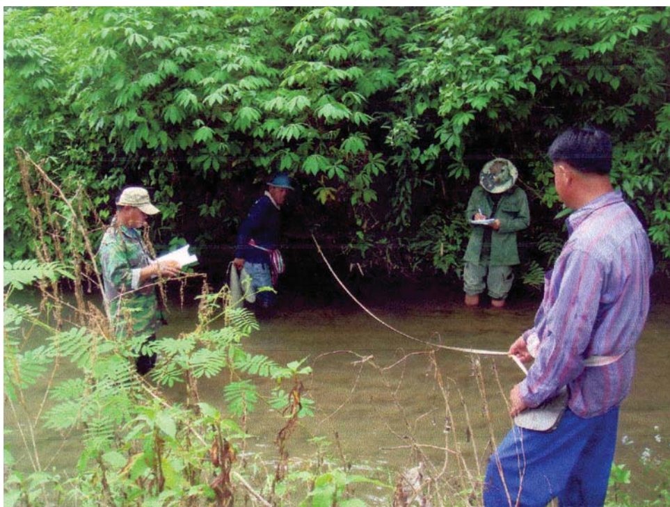
ทีมวิจัยกำลังวัดความลึก – กว้าง ของลำน้ำแม่ก๊ิด ช่วงกลางเส้นทางแม่น้ำก๊ิดก่อนลงสู่แม่น้ำปิง
