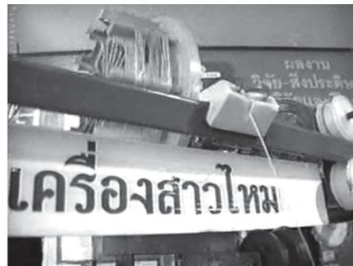
ภาพที่ 6 แสดงการสาวไหมด้วยความเร็วรอบ ที่เหมาะสม
