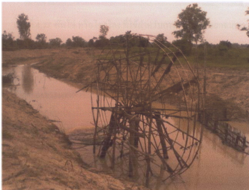
ภาพที่ 4.34 ระหัดวิดน้ำจากภูมิปัญญาชาวบ้านในการนำน้ำจากห้วยแกงเข้าสู่ที่นาเพื่อทำนาปรัง
