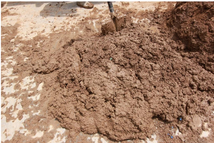
รูปที่ 16 โคลนทรายสำหรับการก่อกำแพง
