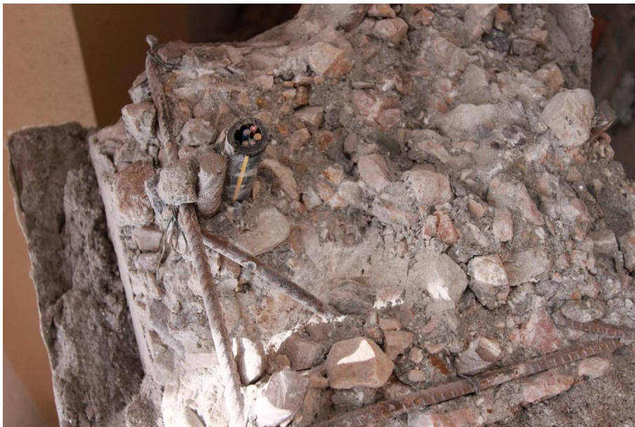
รูปที่ 31 สภาพคอนกรีตหลังการวิบัติที่เป็นลักษณะของการแยกตัวของหินและซีเมนต์ในบริเวณผิวของหิน ซึ่งสามารถกล่าวโดยย่อได้ว่า คอนกรีตนี้เป็นคอนกรีตกำลังต่ำ ถ้าหากเป็นการวิบัติของคอนกรีตกำลังสูง จะมีการแตกผ่านก้อนหิน
