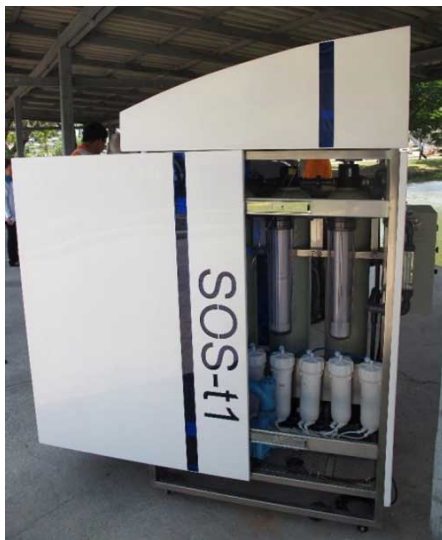
รูปที่ 2.40 เครื่องกรองน้ำดื่มจากน้ำเค็ม SOS-t1 โดย สสนก. ร่วมกับ นาโนเทค (หนังสือพิมพ์เดลินิวส์ ฉบับวันที่ 26 พฤษภาคม 2557)
