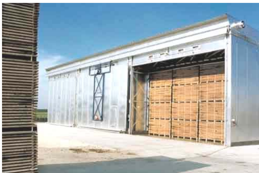
รูปที่ 5 แสดงการอบไม้ในห้องอบไม้แบบ compartment หรือ batch และลักษณะการเรียงกองไม้ในห้องอบ
