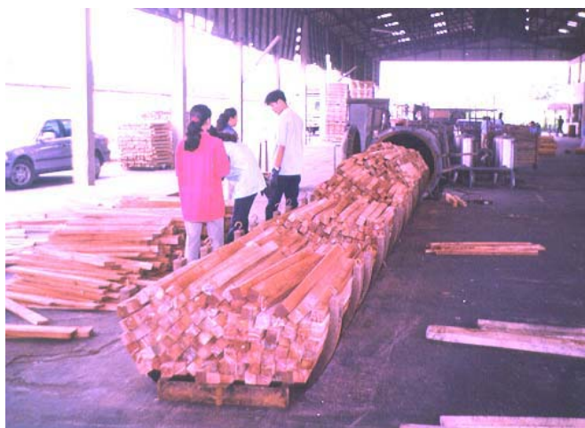
รูปที่ 2 แสดงการคัดเลือกและเรียงไม้เข้าถังอัดน้ำยาป้องกันมอดและเชื้อรา
