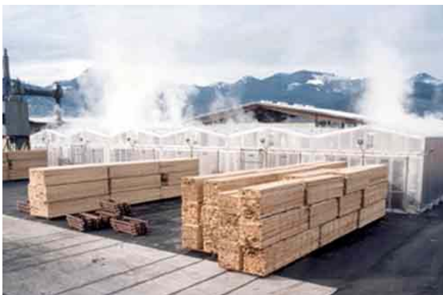
รูปที่ 3 แสดงการอบไม้ด้วยห้องอบแบบ progressive หรือ semicontinuous
