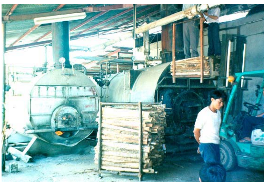
รูปที่ 8 แสดงหม้อกำเนิดไอน้ำที่ใช้ไม้พืนจากเศษไม้ยางพาราเป็นแหล่งความร้อนสำหรับห้องอบไม้
