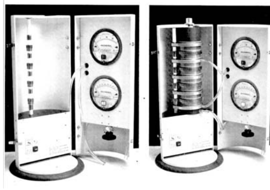
รูปที่ 33 Micro-Orifice Uniform Deposit Impactor (MOUDI) (Marple et al., 1991)
