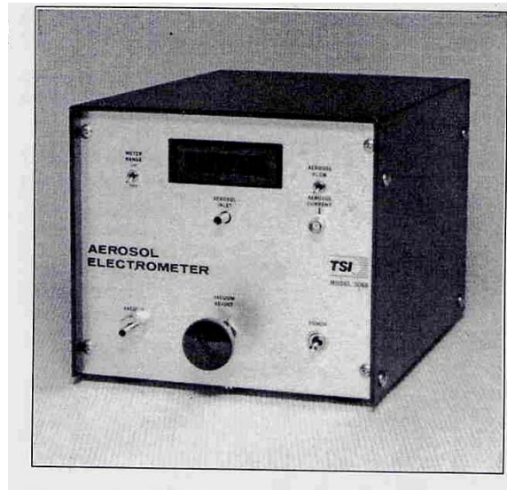
รูปที่ 29 เครื่อง Aerosol Electrometer model 3068 (TSI, Inc., 1990)
